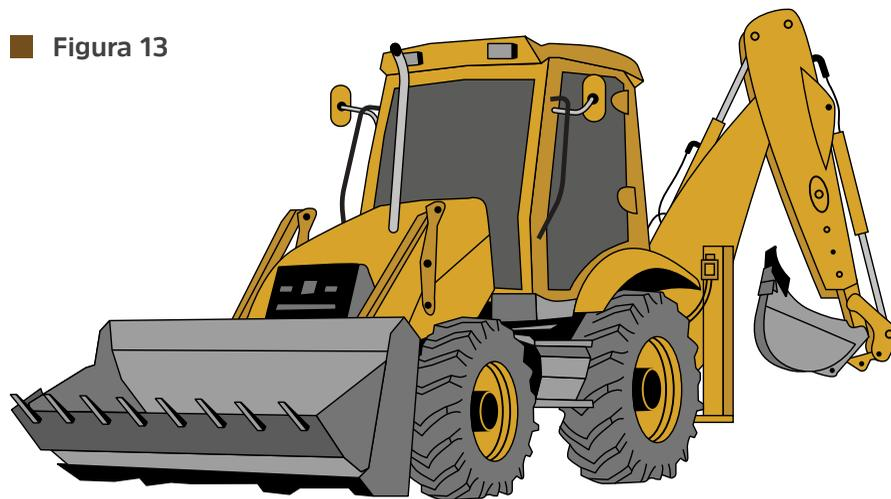
Máquina autopropelida com massa superior a 4.500 kg deve possuir cabine climatizada e oferecer proteção contra queda e projeção de objetos e contra incidência de raios solares e intempéries. Deve ser observado prazo para adaptação.
