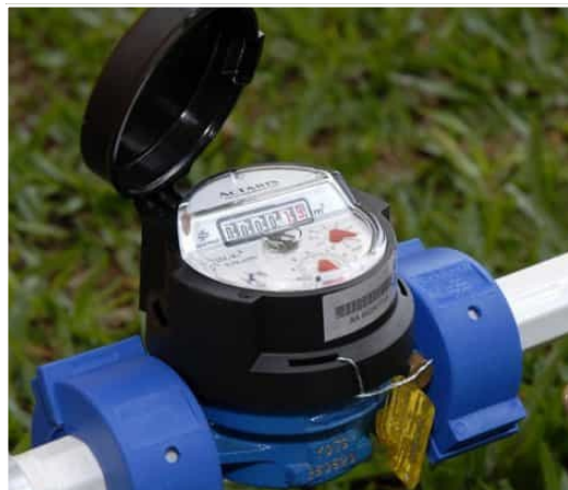
Micromedição: leitura de hidrômetros. Volume consumido.
