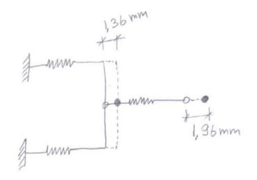
**EXERCÍCIO PROPOSTO 01** – Aplicando o método da Energia Potencial Mínima, determine os valores dos deslocamentos dos nós 1, 2 e 3 (q1, q2 e q3) do sistema estrutural de molas abaixo.
