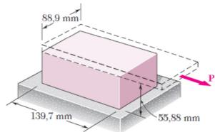
**2.76** A unidade de isolamento de vibrações é formada por dois blocos de borracha dura colados à placa AB e a suportes rígidos conforme mostrado na figura. Para o grau e o tipo de borracha utilizada tem-se  $\tau_{\rm adm}=1517$  kPa e G=12,41 MPa. Sabendo que uma força vertical de intensidade P=14,23 kN deve produzir um deslocamento vertical de 2,54 mm na chapa AB, determine as menores dimensões a e b admissíveis para o bloco.
