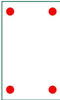
$$A_{s,min} = 4,83 \text{ cm}^2 \rightarrow 4 \phi 12,5 \text{ mm}$$
