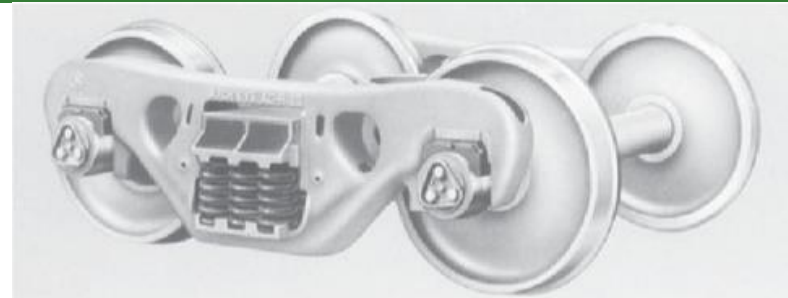
FIGURA 1.24 Arranjo em paralelo de molas em um vagão ferroviário de carga. (Cortesia de Buckeye Steel Castings Company.)
