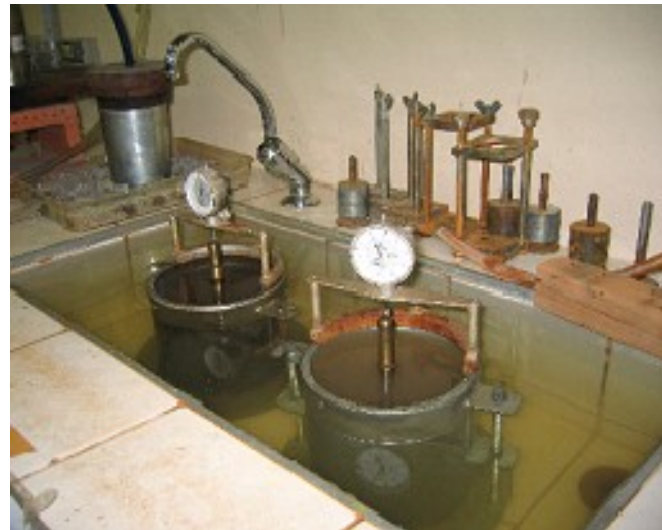
2°. Imersão dos corpos-de-prova em tanque de água por 96 horas e medida de expansão axial
