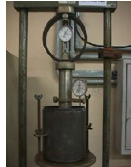
3°. Ensaio de penetração de pistão padrão no corpo-de-prova e medida penetração e resistência
