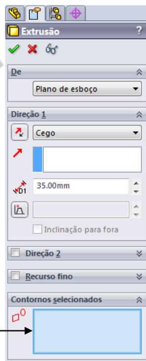
Selecionar a região ressaltada na imagem clicando nela na área de desenho do SolidWorks. Definir a extrusão com 125 mm de profundidade.
