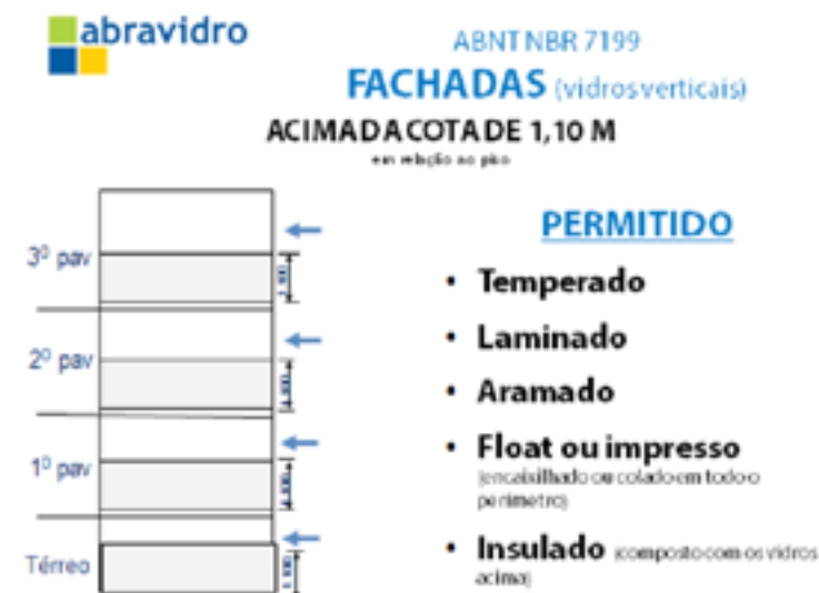
Figura 28 – Aplicação de vidros de segurança acima de 1,10m (Imagem cedida pela Abravidro)
