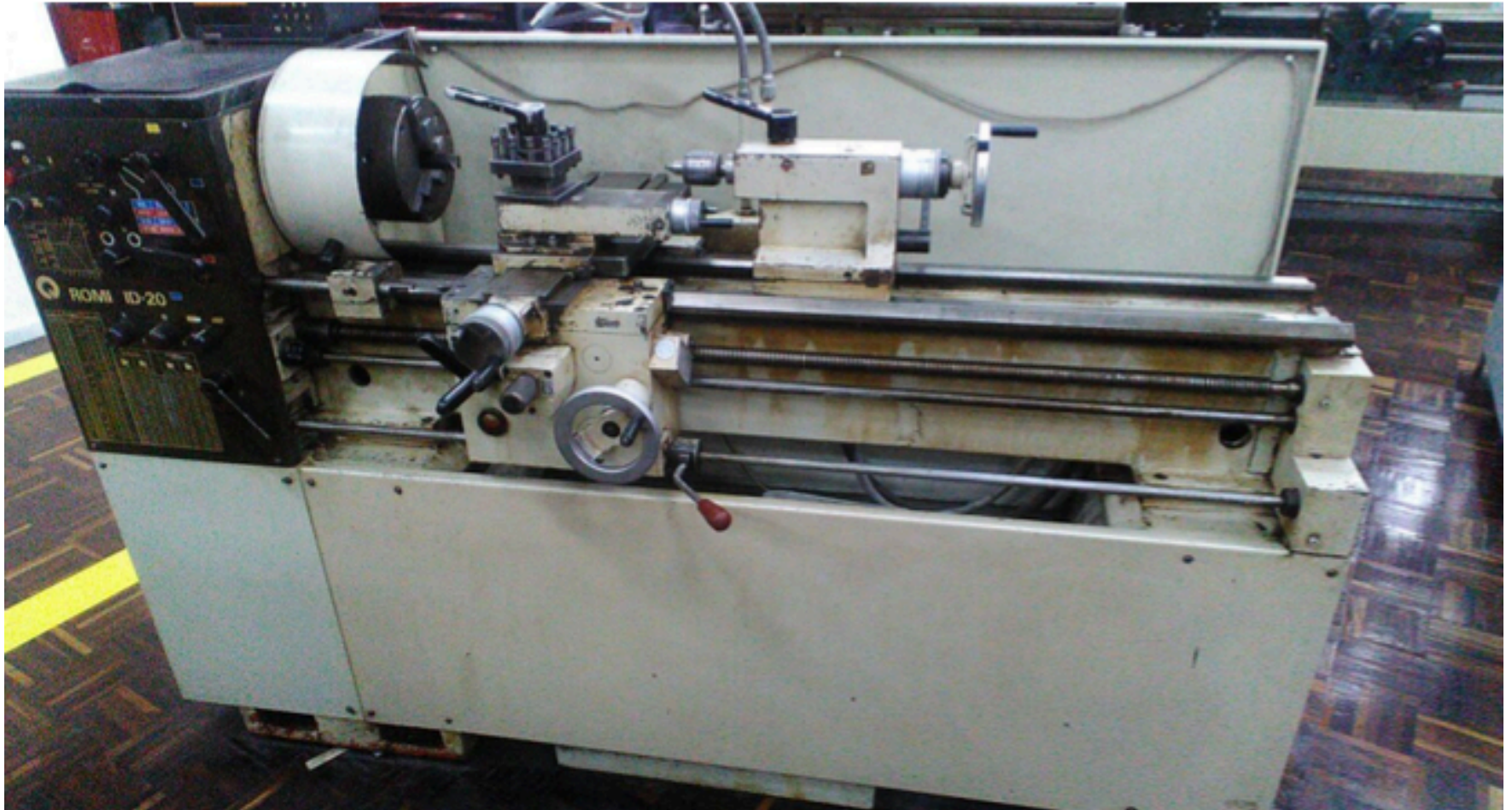
Figura 1 Torno Mecânico Universal, Marca ROMI, modelo ID-20 avaliado quanto a seus aspectos ergonômicos.
