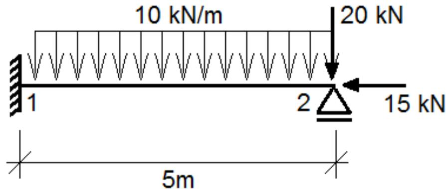
**Exemplo 02** – A viga abaixo será construída com perfil I em aço e solicitada ao carregamento ilustrado. Considerando o módulo de elasticidade do aço 200 GPa e a seção transversal com área de  $105 \text{ cm}^2$  e momento de inércia de  $47569 \text{ cm}^4$ , determinar as reações de apoio e traçar os diagramas de esforços correspondentes.
