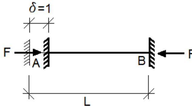
A força  $F$  necessária e capaz de produzir tal deslocamento pode ser determinada a partir dos princípios da Resistência dos Materiais:
