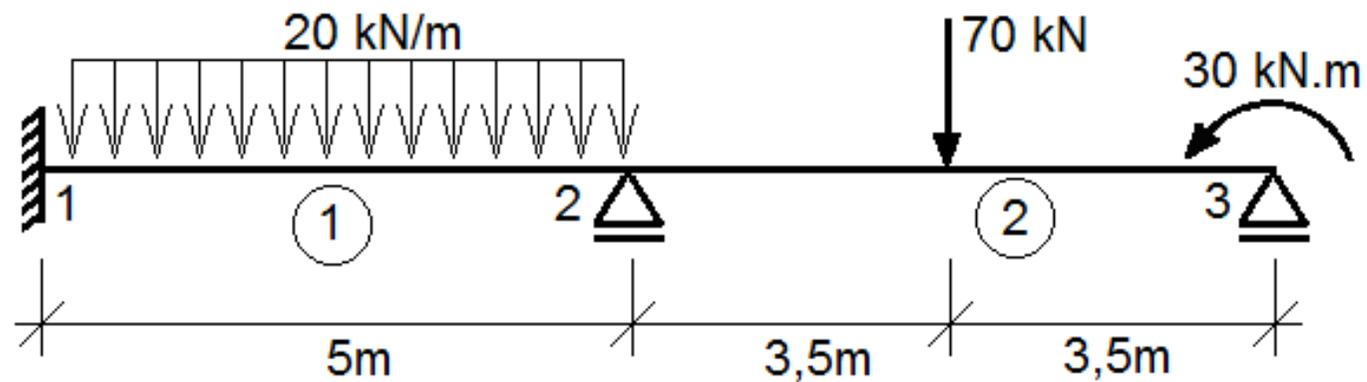
**Exemplo 03** – O pórtico seguinte será construído em concreto armado ( $E = 25 \text{ GPa}$ ) e seus elementos terão seção transversal de  $20 \times 60 \text{ cm}$ . Aplicando o método da rigidez direta de forma matricial, calcular as reações de apoios e traçar os diagramas de esforços correspondentes.
