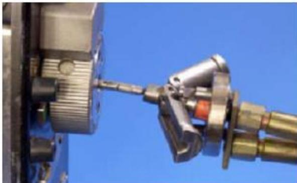
Operação de conexão da fonte de Ir-192 - Fase 2
