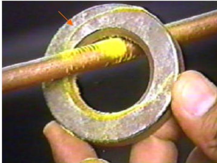
Indicação de trinca detectado pela técnica do condutor central. Observe a linha circular formada na superfície do anel pelo acúmulo do pó magnético.
