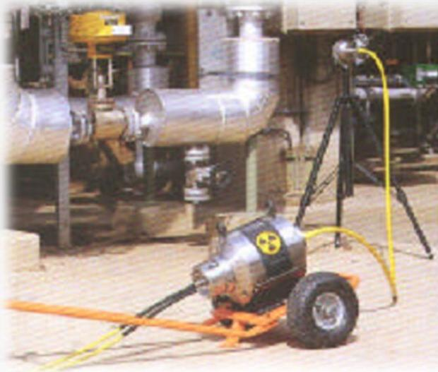
Aparelho para Gamagrafia usando fonte radioativa de Cobalto-60 com atividade máxima de 30 Curies , pesando 122 kg, projetado com tipo de canal reto.
