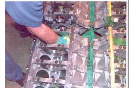
Aplicação do penetrante com pincel . Nas fotos acima penetrante colorido vermelho, e na foto abaixo penetrante fluorescente
