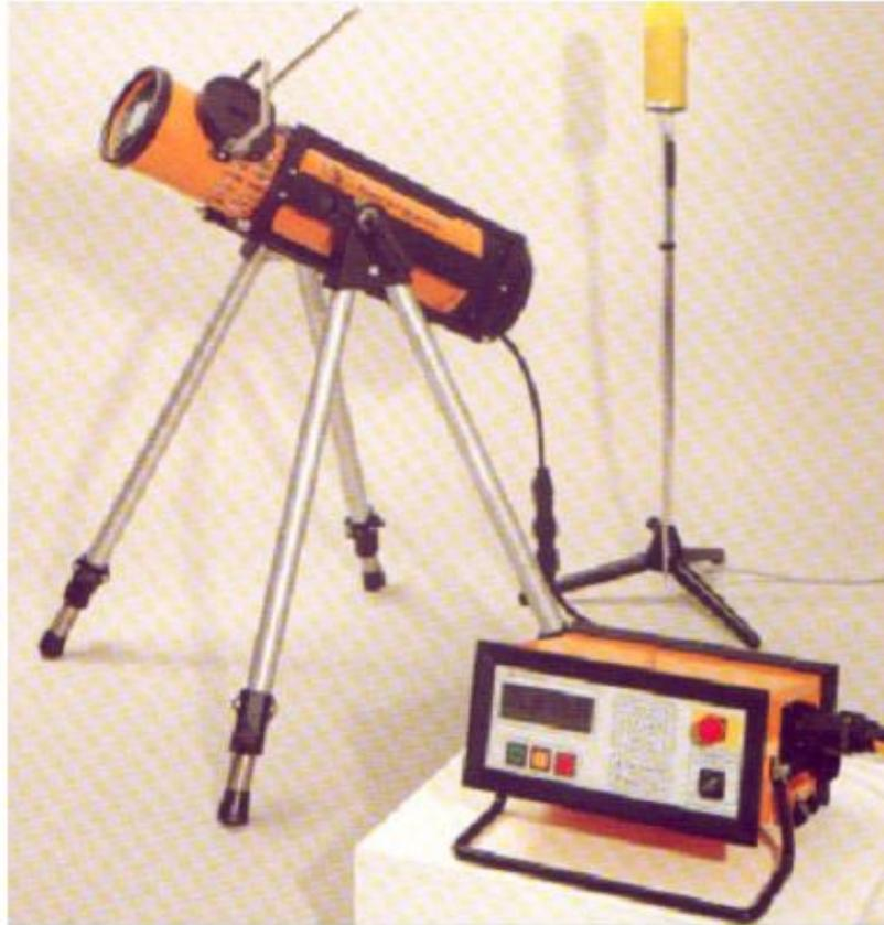
Equipamento gerador de radiação ionizante industrial , direcional, pesando 24 kg e a mesa de comando 13 kg , tamanho focal 1,5 mm , com tensão de 20 a 200 kV e corrente de 0,5 a 10 mA.
