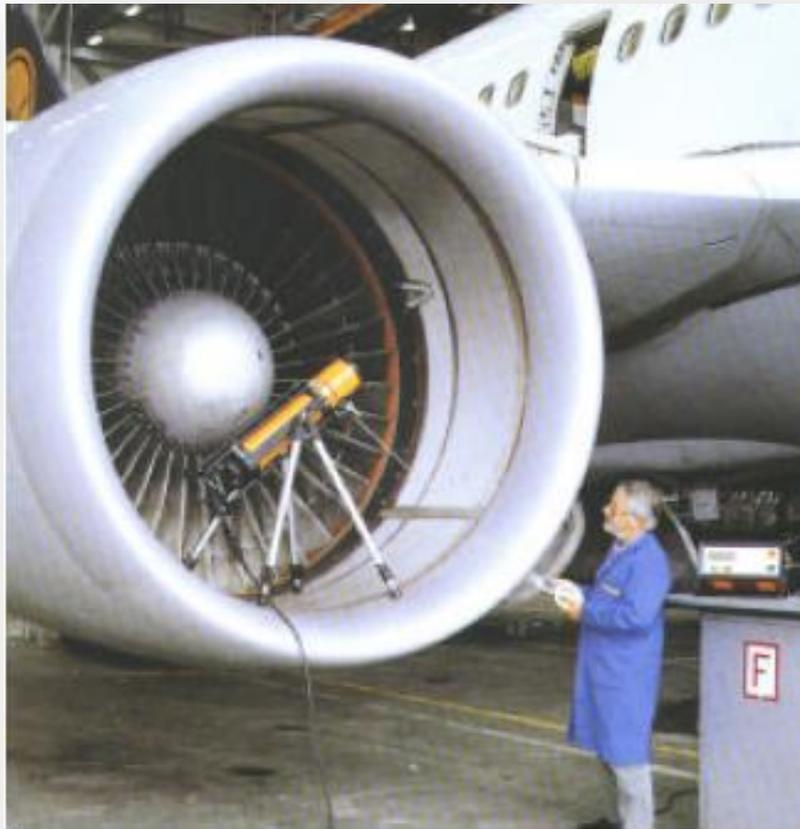
Ensaio Radiográfico da Turbina de um avião
