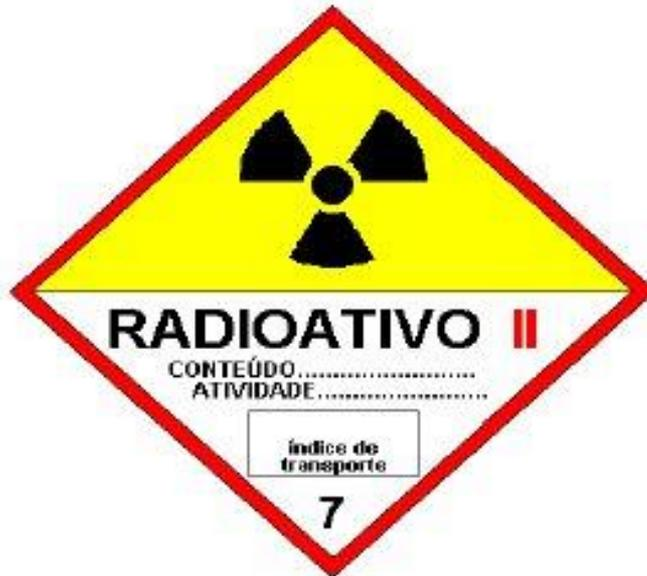
Rótulo de transporte que deve ser fixada no embalado ( container ou irradiador) que identifica o material radioativo, a atividade e o índice de transporte, nas dimensões 10 x 10 cm. O índice de transporte “IT” é a máxima taxa de dose a 1 metro da superfície do container ou blindagem medida em  $\mu\text{Sv/h}$  e dividido pelo fator 10. O índice máximo aceitável é de 10.
