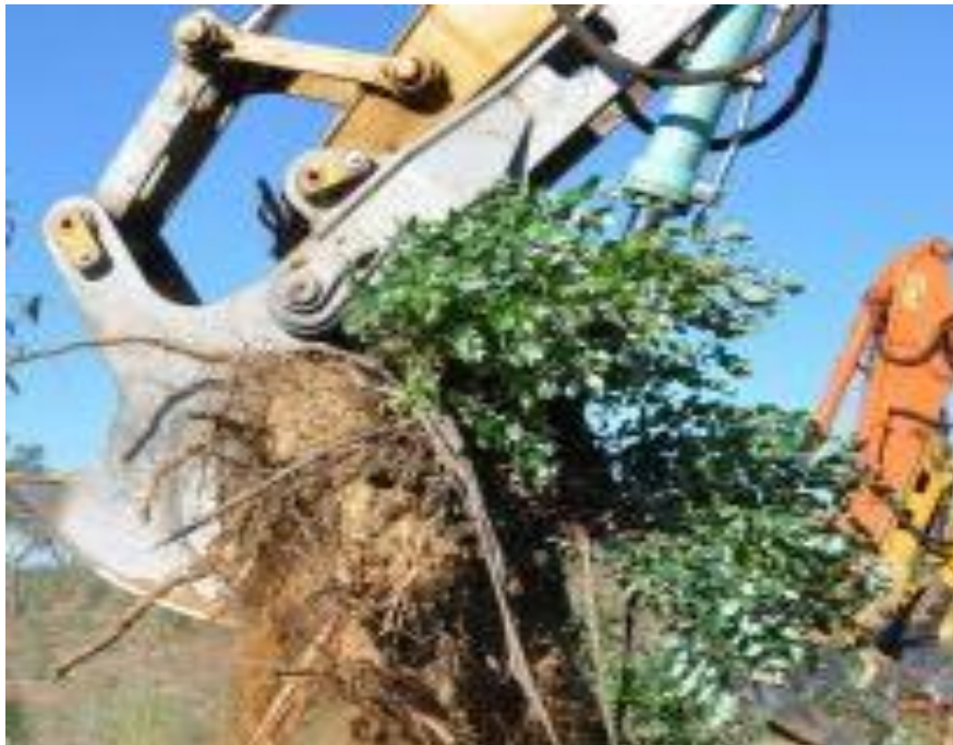
Figura 11 - Rachador (Modelo FRAVIZEL) a arrancar um cepto de eucalipto. [2]
