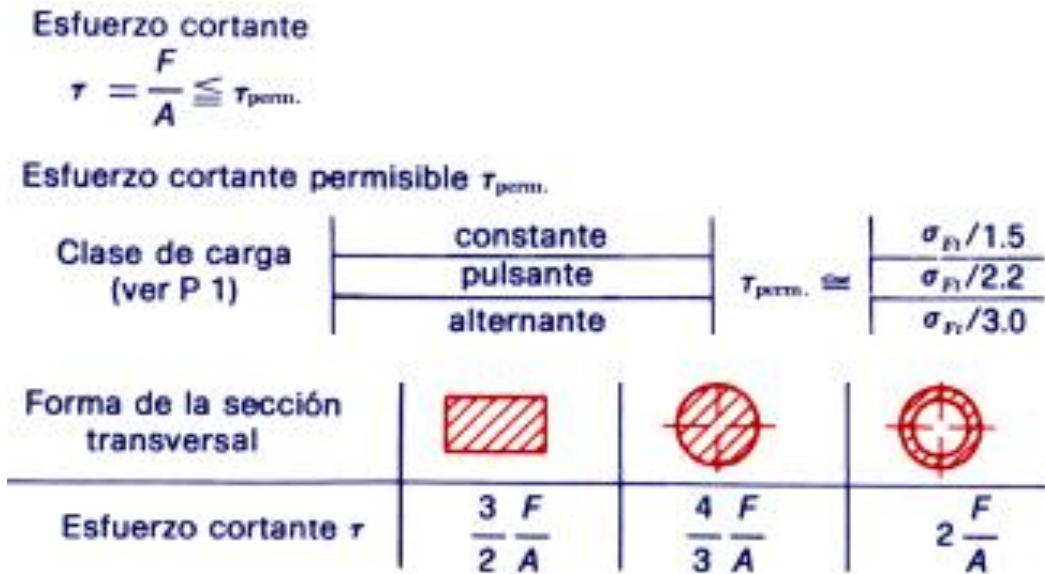
Figura 19 - Fórmulas para cálculo do diâmetro mínimo das cavilhas [Error! Reference source not found.]
